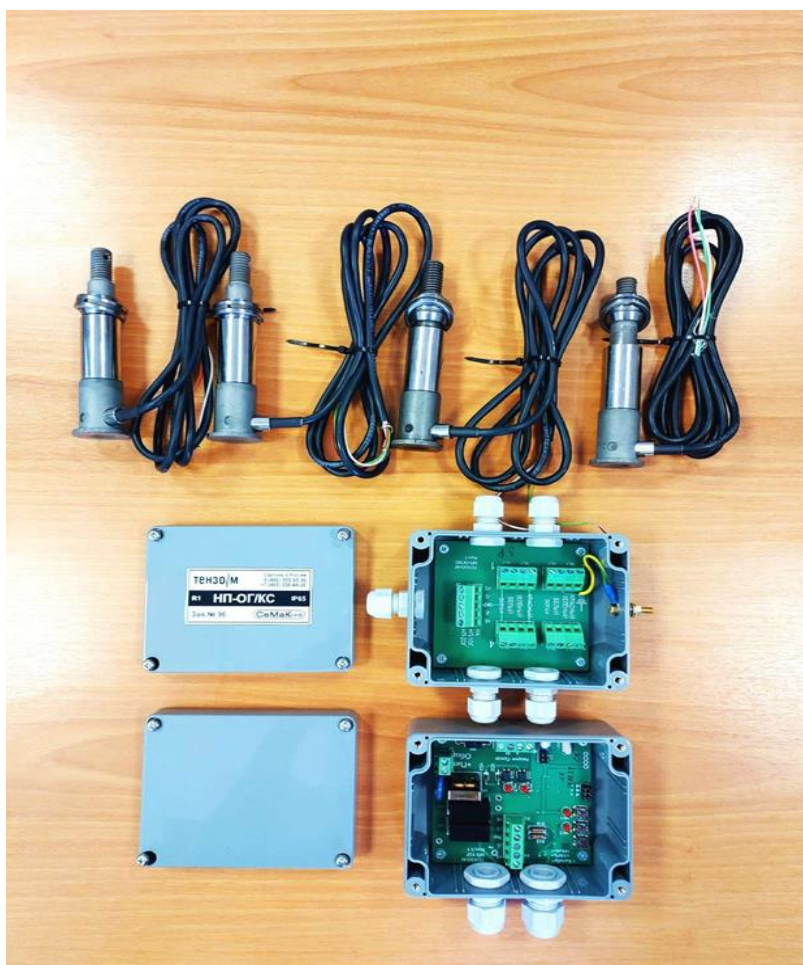
Фото 1. Четыре тензометрических датчиков с подшипниками ШС 15(26) (28),коробка соединительная НП-ОГ/КС и нормирующий преобразователь НП-1ОГ или НП-2ОГ .
